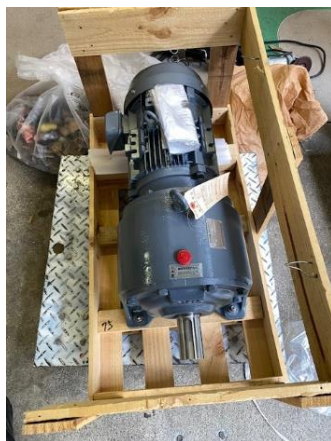
山上駅ベルトコンベアギ アモーター更新工事
